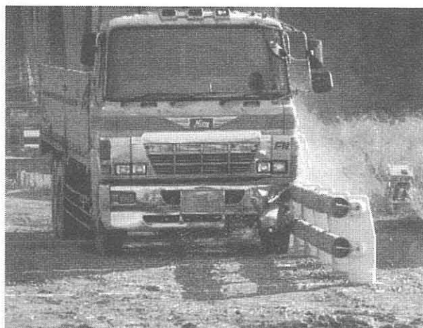
写真 1 木製防護柵の衝突試験
