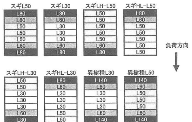
図1 集成材のラミナ構成
