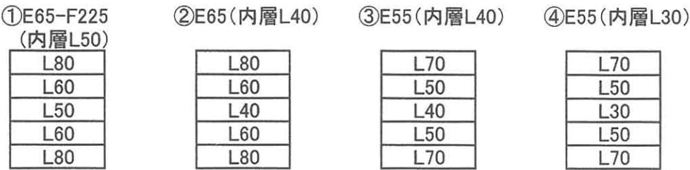
図1 供試した対称異等級構成構造用集成材のラミナ構成
