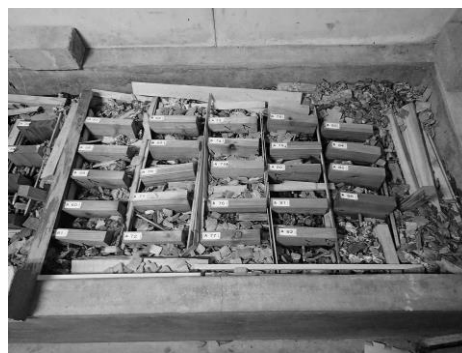
図 1 ファンガスセラー内の試験体設置状況
