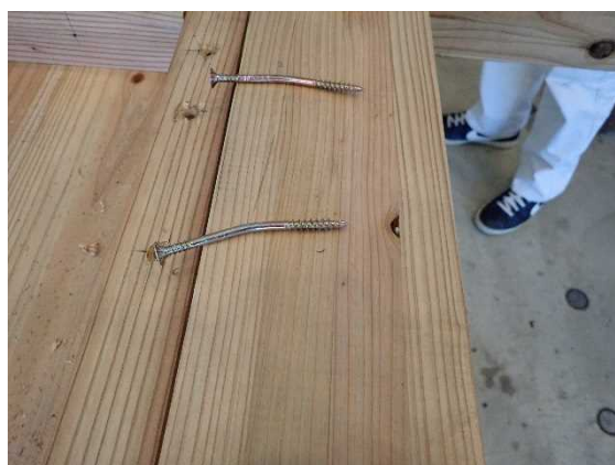
(v) ビス（ML T－受材接合）の損傷状況
