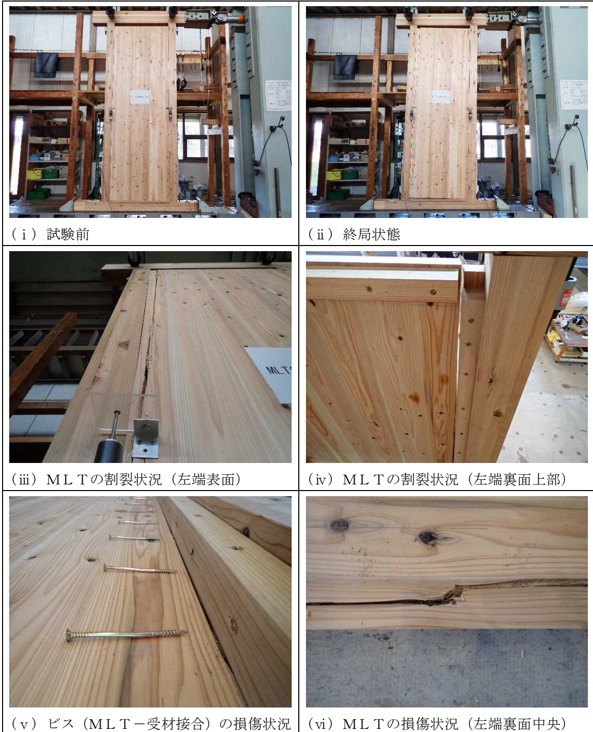
写真 2 標準型－2 試験体の破壊性状
