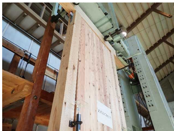
(iii) ML Tの割裂とビスの引き抜け状況（左端表面）
