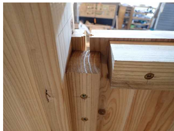
(iv) ML Tの割裂状況（右端裏面上部）
