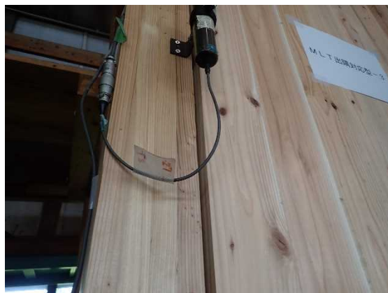
(iii) MLTに対するビスの引き抜け状況 (左端表面)
