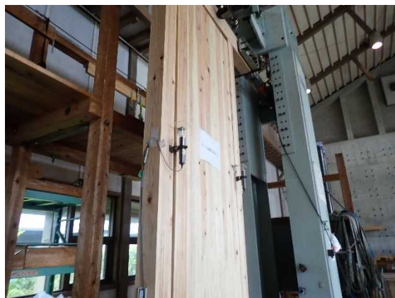
(iii) MLT に対するビスの引き抜け状況
