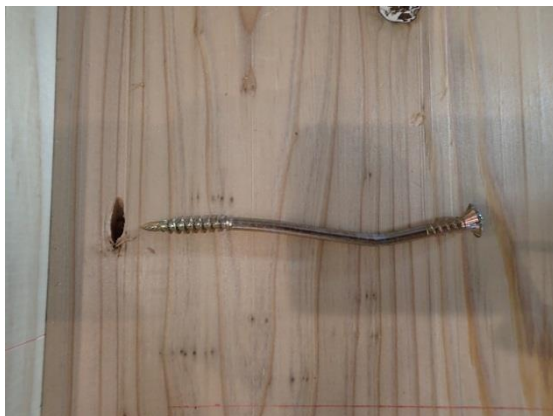
(iii) 大きく曲げ変形したビス
