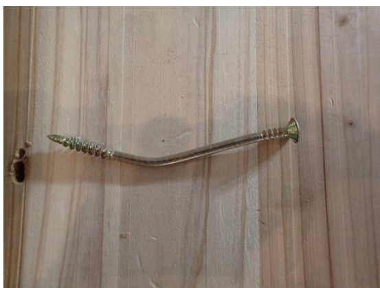
(iii) 大きく曲げ変形したビス
