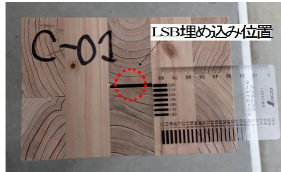
図 2 幅はぎなし(ラミナの横方向の透き間あり)試験体断面
