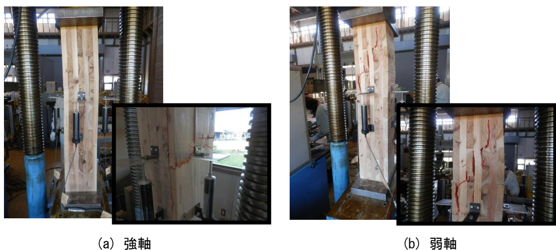
図 29 幅はぎなし試験体の破壊例
