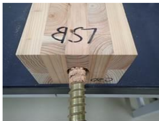
図8 透き間あり試験体の破壊性状
