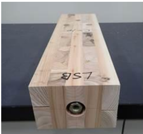
図 3 LSB を埋め込んだ試験体
