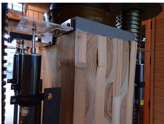
図 30 KN 試験体破壊性状 1 加力部分ラミナの座屈破壊(終局状態)
