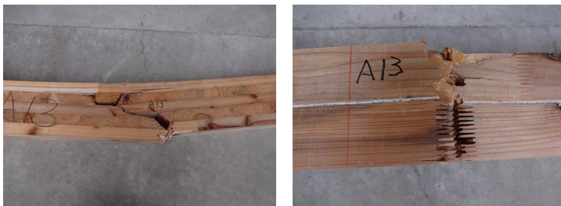
図 21 破壊形態の一例（幅はぎあり CLT）
