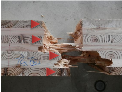
(a) 幅はぎあり試験体
