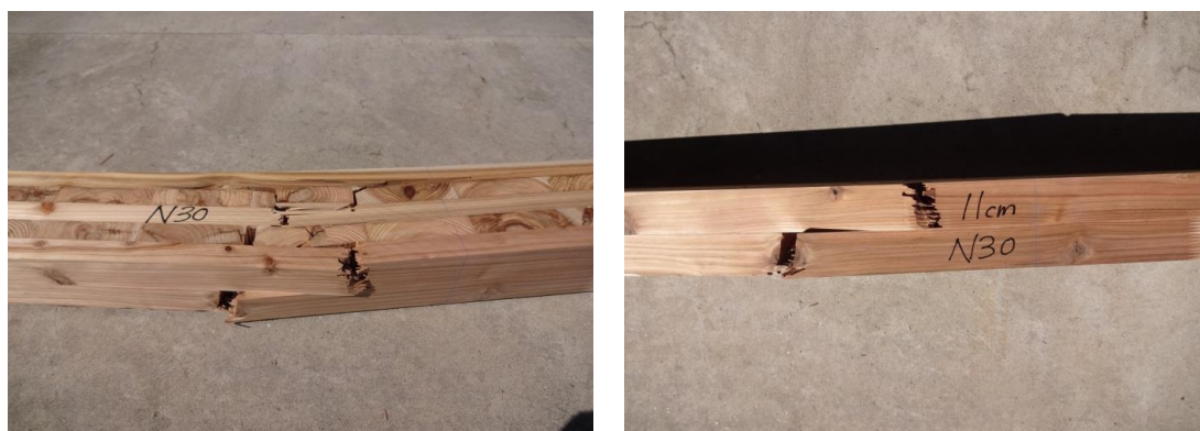
図 22 破壊形態の一例（幅はぎなし CLT）
