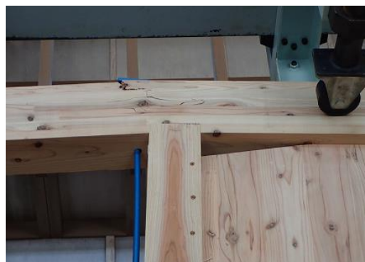
(iv) 梁材の曲げ破壊
