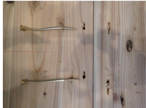
(ii) 曲げ変形したビスと CLT と柱材へのめり込み
