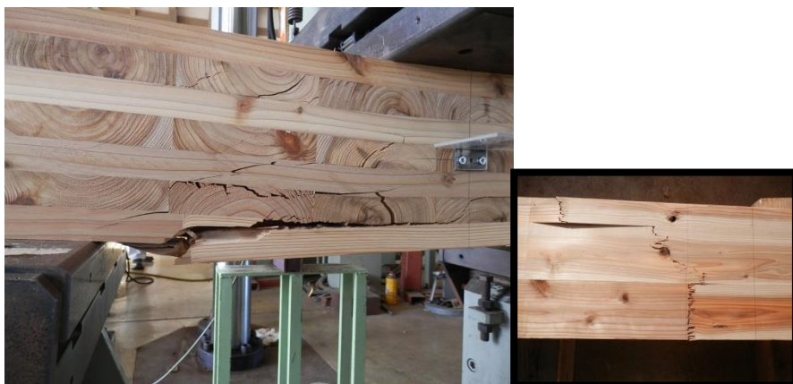
図 19 幅はぎなし試験体の破壊例
