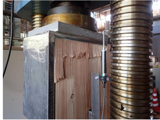
図 35 KS 試験体破壊性状 2 CLT 外層の圧縮破壊(終局状態)
