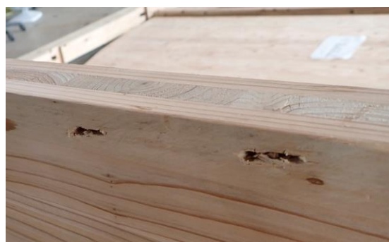
(vi) CLT のビス穴の変形
