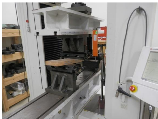
図 1 ラミナの曲げ試験風景
