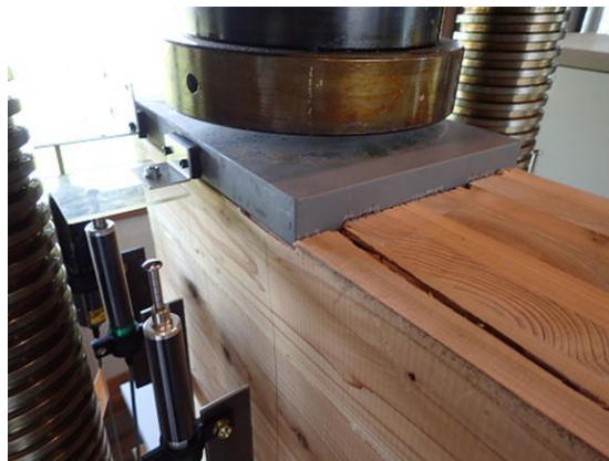
図 29 JN 試験体破壊性状 2 ラミナの剥離破壊(終局状態)
