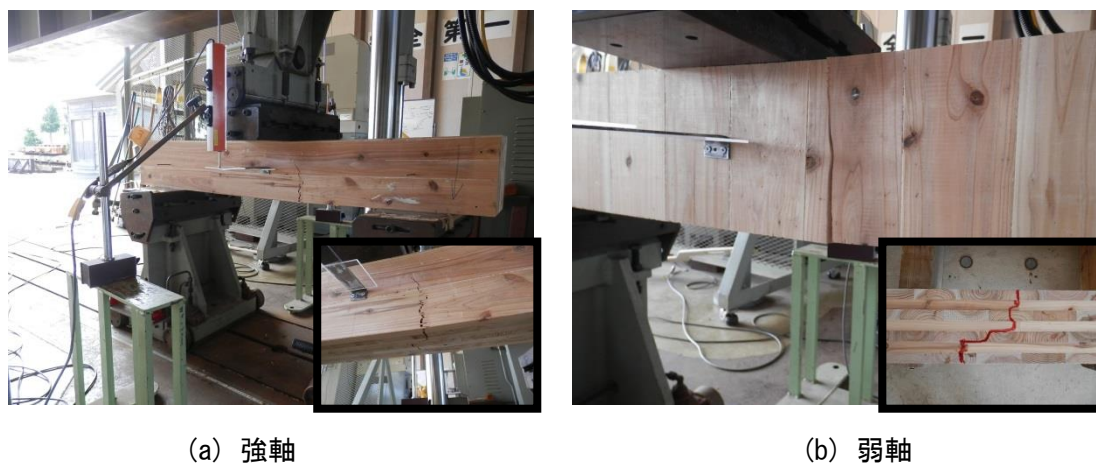
図 23 幅はぎあり試験体の破壊例
