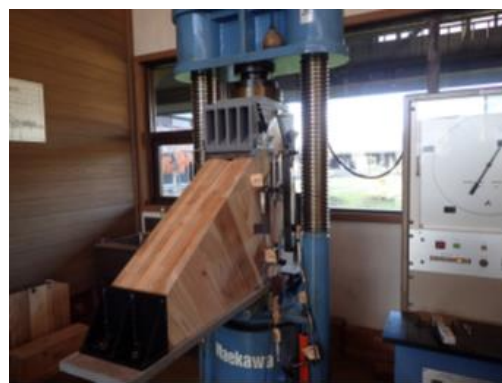
図 22 試験方法 2(斜め試験体)
