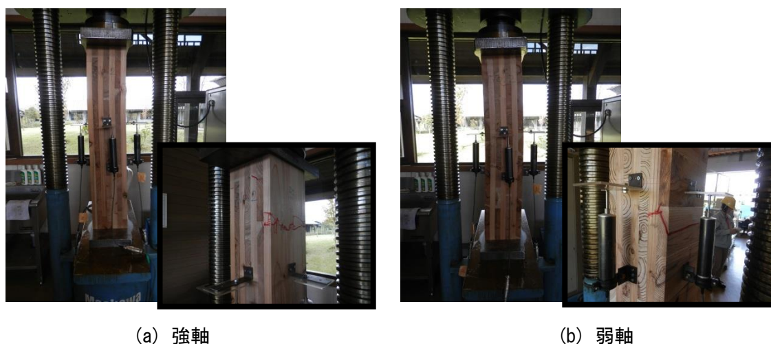
図 28 幅はぎあり試験体の破壊例
