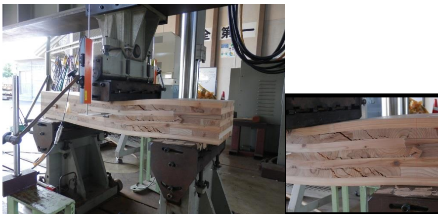
図 18 幅はぎあり試験体の破壊例
