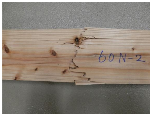
図 2 ラミナの破壊例 (NJ ラミナ)
