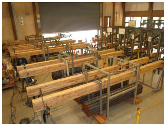
図 7 面外曲げクリープ試験の状況
