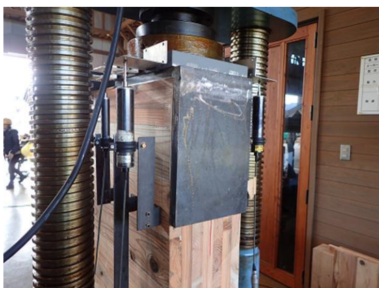
図 32 JS 試験体終局状態 1 金物裏側 CLT ラミナの座屈破壊(終局状態)
