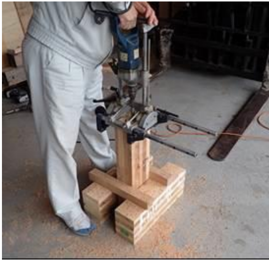
図 1 試験体の製作(先穴の製作)
