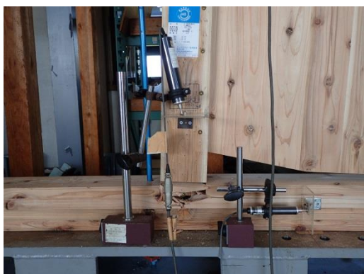
(iii) 柱脚部の破壊
