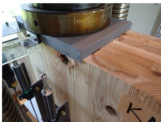
図 31 KN 試験体破壊性状 2 圧縮治具の大きなめり込み破壊(終局状態)
