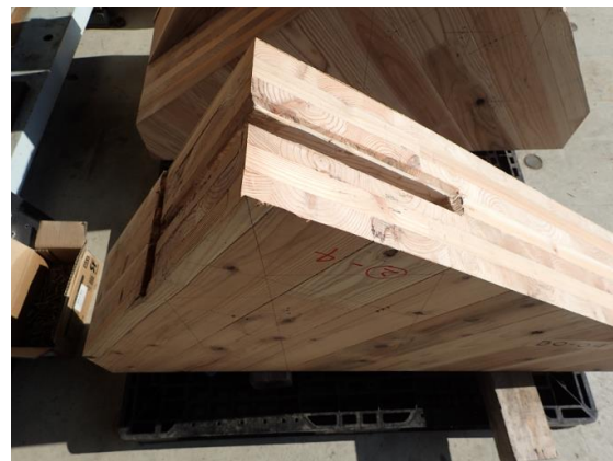
図 37 B0 試験体破壊性状 2 CLT 弱軸側の大きなめり込み
