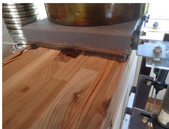
図 33 JS 試験体破壊性状 2 接合金物の大きなめり込み(終局状態)
