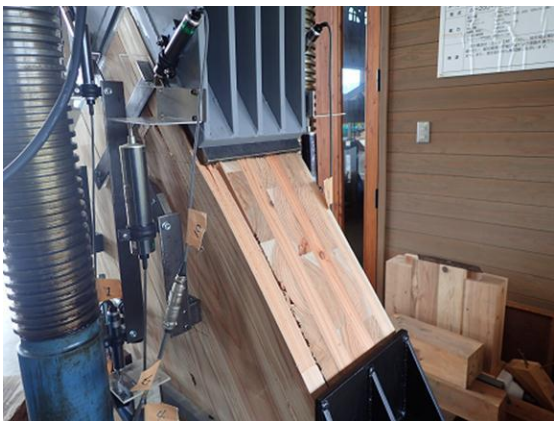
図 36 B0 試験体破壊性状 1 めり込みからのラミナ剥離(終局状態)
