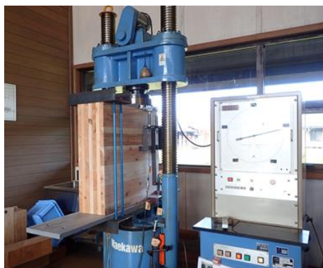
図 21 試験方法 1(弱軸スリットなし)
