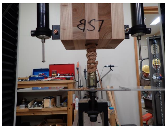
図7 LSBの引き抜き破壊
