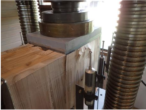
図 34 KS 試験体破壊性状 1 接合金物の大きなめり込み(終局状態)
