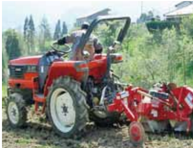
オペレーターの畦塗り作業
