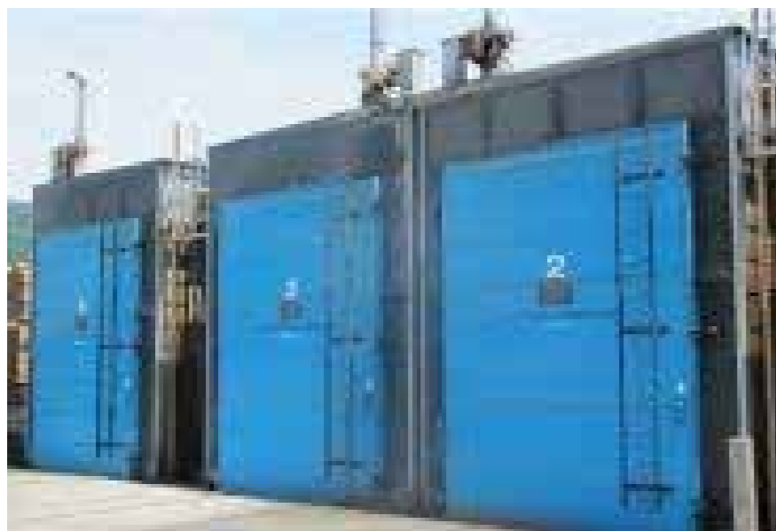
蒸気式中温・高温乾燥機
